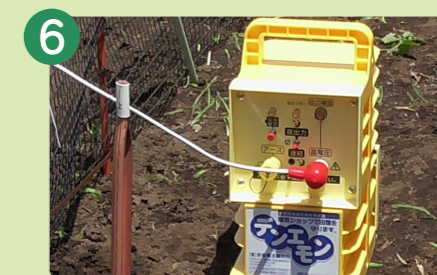
電気柵本機の設置 (本機・アース・危険表示板など)
