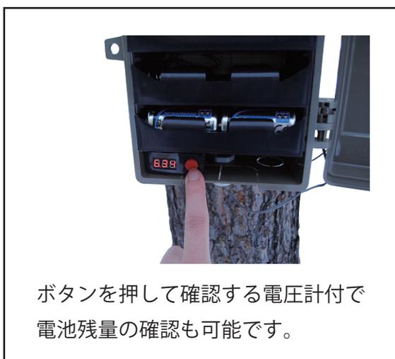
ボタンを押して確認する電圧計付で電池残量の確認も可能です。
