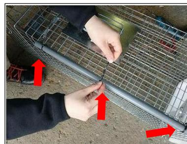
連動ワイヤーを保護するパイプを結束バンドを用いて取り付けてください。
