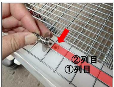
上部と左右にある3か所のネジ穴に、蝶ネジ、スプリングワッシャー、平ワッシャーを用いてトリガーモジュールを固定してください。トラップのメッシュ位置は2列目です。蝶ネジは仮止めで3点とめた方がスムーズに取り付けられます。
